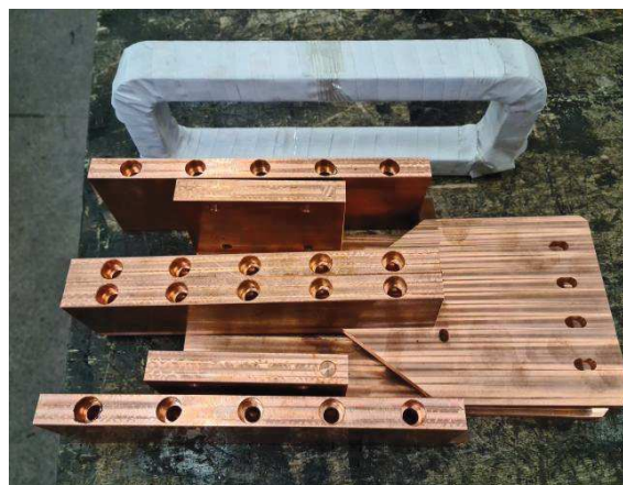
Rys.10. Rdzeń oraz elementy uzwojenia transformatora typu 1TTFW-95 550//15V 10kHz 6kA S3 WF=4l/min
