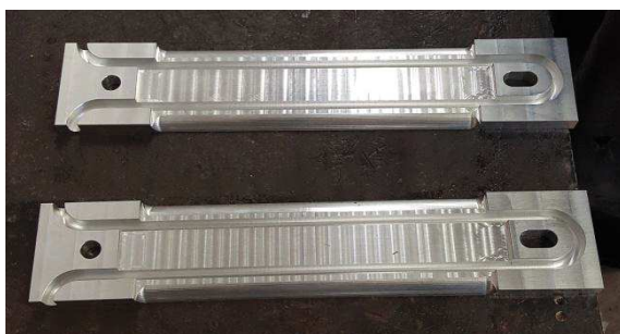
Rys.5. Chłodnice panelowe dławika filtru LC z pośrednim chłodzeniem wodnym
