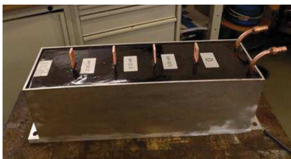
Rys. 9. Jednofazowy dławik z odczepami typu 1RTFW-0,05-0,12-0,16mH / 300A 25kHz z pośrednim chłodzeniem wodnym
