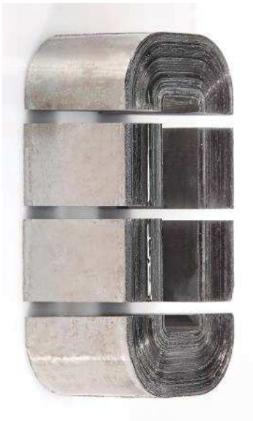
Rys1. Szczelinowy rdzeń dławikowy, materiał nanokrystaliczny na bazie żelaza Fe-Cu-Nb-Si-B
