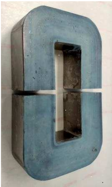
Rys1. Kolumnowy rdzeń transformatorowy, materiał nanokrystaliczny na bazie żelaza Fe-Cu-Nb-Si-B
